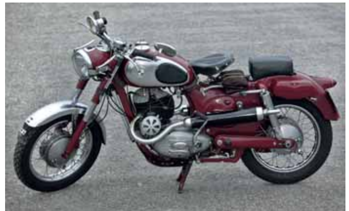
■ Het revolutionaire Puch 'schaalframe' was een zelfdragende constructie waarin het achterspatbord één geheel vormde met het hoofdframe.
